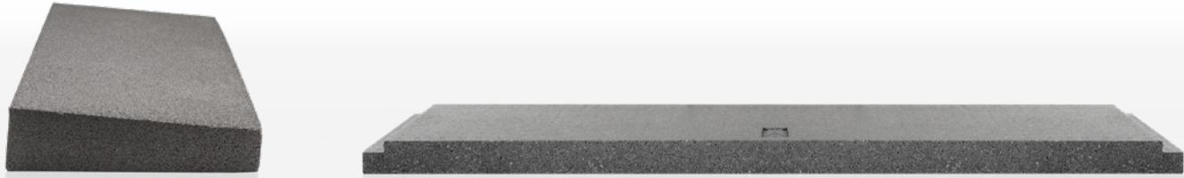
Das blaugelb Thermofensterbankprofil dient zur Ausbildung einer 5° Neigung im Brüstungsbereich. Durch das blaugelb Thermofensterbankprofil wird beim Anbringen der Außenfensterbank die richtige Schräglage (ca. 5° Neigung) eingehalten. Durch die punktuelle blaugelb Hybrid Polymer Power Fix Fixierung mit der druckfesten und stabilen Basis unter der Außenfensterbank wird das Abheben der Fensterbank verhindert.
