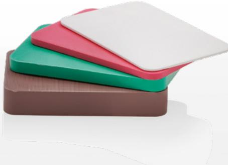
Der blaugelb Montageklotz, hergestellt aus hochwertigem Polypropylen, ist wegen seines massiven Aufbaus im Vollgussverfahren ideal zur fachgerechten Lastabtragung bei der Fenster- und Türenmontage geeignet. Seine Randverbundverträglichkeit macht ihn ebenso wie die hohe Drucklast zu einem wichtigen und unverzichtbaren Helfer. Die Feinriffelung an der Oberfläche der blaugelb Montageklotze sorgt für eine hohe Rutschfestigkeit und somit auch für mehr Sicherheit beim Ausgleichen.
