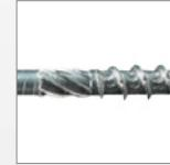
Die blaugelb Tellerkopfschraube gewährleistet eine effektive Kraftübertragung sowohl entlang der Schraubachse als auch quer dazu. Und Dank des Teilgewindes und des Tellerkopfes ermöglichen die Schrauben eine flächenpressende Verbindung zwischen zwei Werkstücken oder Bauteilen. Die blaugelb Tellerkopfschrauben weisen darüber hinaus einen dimensionierbaren Standsicherheitsnachweis der Verbindung gemäß EN 1995 auf, was ihre Anwendung in verschiedenen Bauprojekten zulässt.
