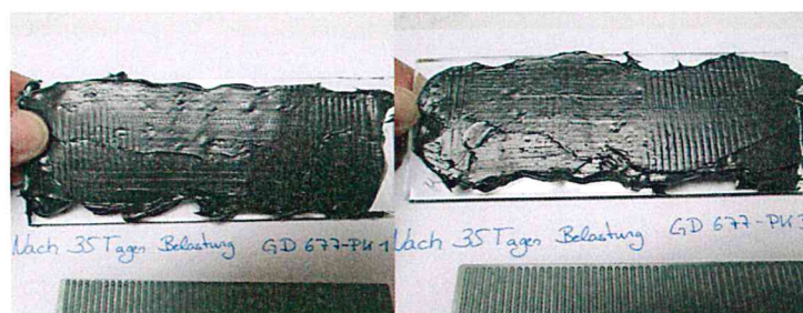
Bild 2 und 3 Probekörper nach 35 Tagen Lagerung im Ofen bei 70 °C
